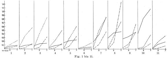
Graphische Darstellung der Resultate der Untersuchung der Oele Nr. 1 bis 11. Abszissen: Prüfdauer (3 und 7 Tage).
