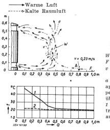
in der Nähe des Heizapparates W Wirbel. F Fussboden. Luftgeschwindigkeit im Punkt A. a Abstand vom Heiz-
