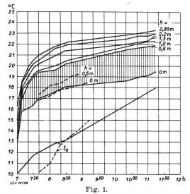
Lufttemperatur bei Heizung durch elektrischen Ofen mit forcierter Luftumwälzung und durch Konvektionsofen, bei verschiedenen Höhen h über dem Boden.
