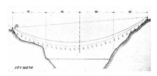
Fig. 2. Leiterseil mit 5 kg/m belastet; Erdseil ohne Zusatzlast.
