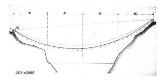
Fig. 1. Leiterseil und Erdseil unbelastet.
