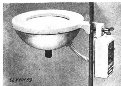
Beschreibung: Elektrische Heizcalotte für Laboratorien gemäss Abbildung. Heizspiralen fest in einem Körper aus keramischem Material eingebaut. Zwischen letzterem und Leichtmetallgehäuse ca. 2,5 cm Schlackenwolle. Stufenschalter zur Regulierung für  $\frac{1}{3}$ ,  $\frac{2}{3}$  oder  $\frac{3}{3}$  der Heizleistung. Anschlussklemmen und Erdungsschraube vorhanden.
