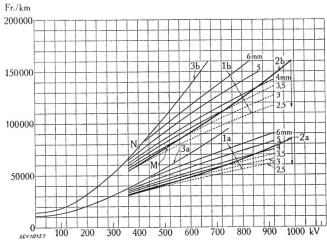
Anlagekosten von Gleichstromleitungen in Funktion der Betriebsspannung, mit Leitern, die für die Koronagrenze nach Fig. 4 dimensioniert sind
