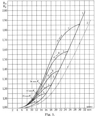
Skineffekt in Voll- und Hohlleitern bei Wechselstrom von 50 Hz
