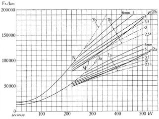
Fig. 7. Anlagekosten von Drehstromleitungen in Funktion der Betriebsspannung, mit Leitern, die für die Koronagrenze nach Fig. 4 dimensioniert sind
