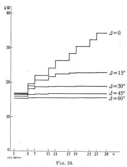
Zusätzliche Verluste in einem Mutatortransformator, Summe der Kupferverluste der n ersten ungeraden Oberwellen n Ordnungszahlen der ungeraden Oberwellen. \( \Delta\) Ueberlappungswinkel.
