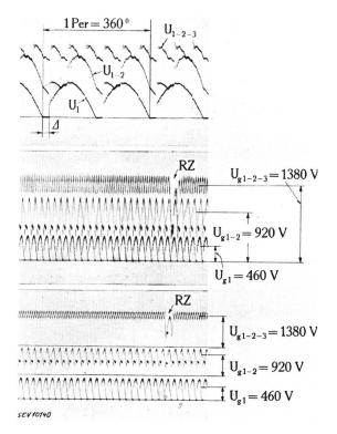
Fig. 19. Spannungen der einzelnen Elemente einer kleinen Mutatorgruppe nach Fig. 6
