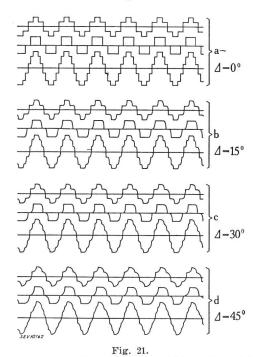
Primärströme und Netzstrom einer kleinen Doppeleinheit nach Fig. 10 Mit steigendem Ueberlappungswinkel A wird die Kurvenform des Netzstromes stark verbessert.
