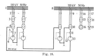
Prinzipschema einer Gleichstrom-Uebertragungsanlage Links: Sendestation. Rechts: Empfangsstation.
