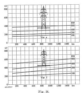
Verlauf der wirtschaftlich günstigsten Spannung für Drehstrom und Gleichstrom in Abhängigkeit der Distanz (Tabelle I) Variante a: Drehstrom-Doppelleitung. Variante f: Gleichstrom-Doppelleitung.
