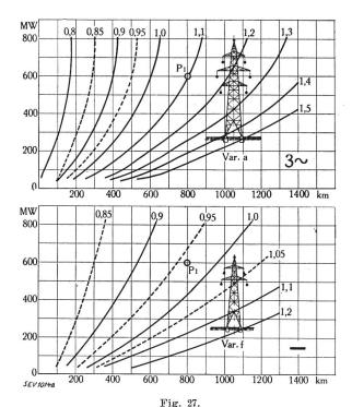
Kurven gleicher, minimaler Energiepreise in Rp./kWh am Leitungsende für Drehstrom (oben) und Gleichstrom (unten) unter Voraussetzung günstiger Annahmen (Tabelle I).
