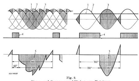
Strom- und Spannungsverhältnisse von Mutatoren Links: Sechsphasen-Schaltung. Rechts: Gegentakt-Schaltung
