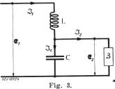
Strom-Spannungs-Gesetz von Boucherot
