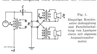
seite nicht benutzt, sondern man geht primärseitig mit einem Kondensator auf die Lautsprecher-Kombination (Fig. 1). Der eingebaute, so nicht belastete Transformator wirkt dann als Anodendrosselspule mit hoher Impedanz. Der Kondensator C soll mindestens 2 µF gross sein; man kann dafür auch einen kleinen billigen Elektrolytkondensator von ca. 4 μF nehmen, der richtig gepolt und für die Anodenplus Gitter-Vorspannung der Endröhre plus Wechselspitzenspannung dimensioniert sein muss.
