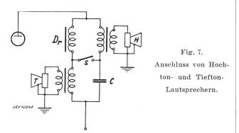
dargelegt. Bei geöffnetem Schalter S sind die beiden Lautsprecher parallel geschaltet, die Drosselspule Dr bildet einen Vorwiderstand zum Tiefton-Lautsprecher T für die hohen Töne, und der Kondensator C einen solchen zum Hochton-Lautsprecher H für die tiefen Töne. Bei S geschlossen sind die Lautsprecher in Serie geschaltet, Dr bildet einen Nebenwiderstand zu H für die tiefen Töne und C
