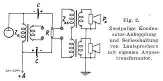
selspannungsspitze nie den als Vorspannung wirkenden Spannungsabfall am Ausgangstransformator überschreitet; andernfalls sind Elektrolytkondensatoren nicht anwendbar.
