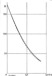
nach den obigen Ausführungen berechnet. Das Resultat ist in Fig. 9 zusammen mit dem oszillographisch bestimmten Stromverlauf aufgetragen, und man ersieht eine sehr gute Uebereinstimmung zwischen Berechnung und Messung.
