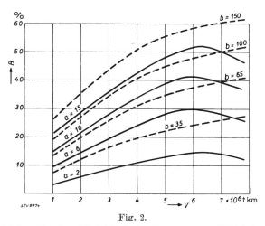
Betriebstoffkosten (B) (elektrische Energie resp. Kohle) in % der gesamten Jahreskosten in Abhängigkeit der jährlichen Verkehrsmengen (V) in Tonnenkilometern bei verschiedenen Energie- und Kohlen-Preisen.
