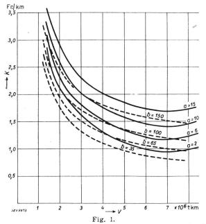
Gesamte Jahreskosten (K) in Fr. pro Zugskilometer in Abhängigkeit der jährlichen Verkehrsmengen (V) in Tonnenkilometern bei verschiedenen Energie- und Kohlen-Preisen.
