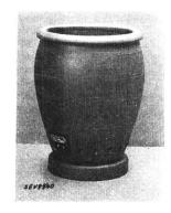
Beschreibung: Elektrischer Heizofen aus gebranntem Ton Abbildung. standsspiralen in Rillen eines zylindrischen Körpers aus gebranntem Ton eingelegt. Apparatestecker für den Anschluß der Zuleitung.
