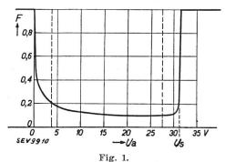
Rauschfaktor F als Funktion der Anodenspannung Im Teil zwischen den gestrichelten Vertikalen ist der Verlauf nach Gl. (14) berechnet, während in der Nähe von  $U_a = 0$  und  $U_a = U_s$  numerische Berechnungen angewendet werden.
