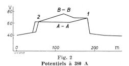
1, 2 Potentiels des conduites forcées. A-A, B-B Potentiel le long des sections indiquées dans la fig. 1.
