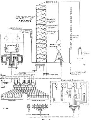
Fig. 6. Schaltschema der Stossanlage.
