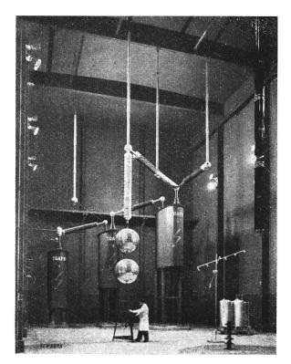
Fig. 3. Prüftransformatoren für 1000 kV, 50 Hz.
