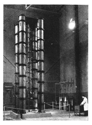
Fig. 5. Stossgenerator für 2000 kV.
