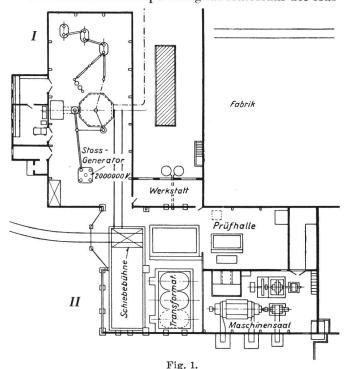
Situationsplan der Halle Maßstab 1:600 I Hoehspannungslaboratorium. II Hoehleistungs-Prüfanlage
