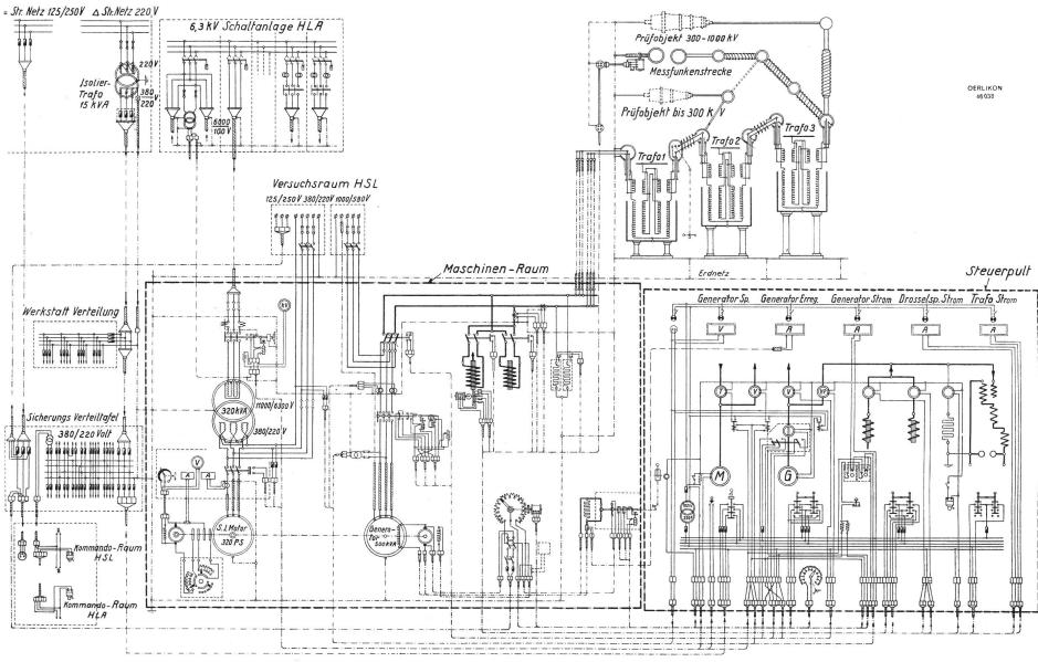
Fig. 4. Schaltschema der 50-Hz-Prüfanlage.
