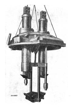
Fig. 12. Ein Pol des Schutzschalters für 1 000 000 kVA Abschaltleistung.
