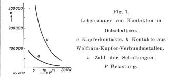
Aus Fig. 7 ist zu ersehen, dass die Lebensdauer des Verbundmaterials ca. viermal so lang ist als die Lebensdauer des Kupferkontakts. Diese Tatsache hängt mit der geringen mechanischen Abnützung des Verbundmaterials infolge seiner hohen Härte und schliesslich mit der ausgezeichneten Wärmeleitfähigkeit derartiger Materialien zusammen. Ferner spielt die geringe Verdampfungsgeschwindigkeit des Wolframs gegenüber dem Kupfer in diesem Falle noch eine grosse Rolle.
