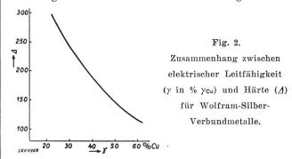
Standardkupfer angegeben. An dieser Stelle sei ausdrücklich hervorgehoben, dass diese verschiedenen Leitfähigkeiten und Härten, sowie die verschiedenen Dichten der Verbundmetalle keineswegs nur durch das Mischungsverhältnis zwischen den zwei oder mehreren Grundmetallen hervorgerufen sind. Alle diese physikalischen Eigenschaften werden in hohem Masse bestimmt durch die Art der ursprünglichen Pressung, durch die verschiedenen Wärmebehandlungen (Bestimmung von Sintertem-
