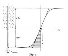
Canal conducteur caché partiellement dans le nuage. Densité superficielle  $\sigma_s$  de la charge du canal en fonction de la distance x.
