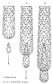
Fig. 1. Trois phases de la propagation du bout négatif du canal et de la formation simultané d'une avalanche élémentaire.
