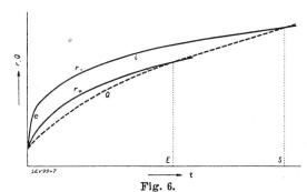
Conditions dans la pause entre deux flèches: rayon  $r_+$  du bout positif, rayon  $r_-$  de l'extrémité négative dans la phase électronique e et ionique i, charge Q du canal — en fonction du temps t.
