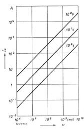
Fig. 4. Courant principal  $i_{\rm P}$  en fonction de la vitesse  $v_{\rm r}$  pour différentes valeurs de  $(U_0+U_{\rm S}-U_{\rm R})$ .
