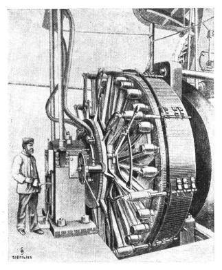
Fig. 9. Innenpolmaschine von Siemens & Halske, seit 1886.
