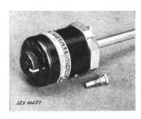
Beschreibung: Eintauch - Temperaturregler gemäss Abbildung, mit einpoligem Momentschalter und Sicherheitsvorrichtung gegen Ueberhitzung von Druckund Entleerungs-Heisswasserspeichern. Drehknopf für Temperatureinstellung. Schutzkappe aus Kunstharzpreßstoff.
