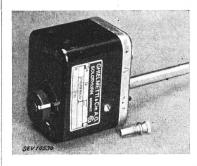
Beschreibung: Eintauch - Temperaturregler gemäss Abbildung mit zweipoligem Momentschalter und Sicherheitsvorrichtung gegen Ueberhitzung von Druckund Entleerungs-Heisswasserspeichern. Drehknopf für Temperatureinstellung. Schutzkappe aus Kunstharzpreßstoff.
