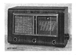
Beschreibung: Kombinierter Radio- und Telephonrundspruchapparat gemäss Abbildung. Apparat für den Empfang langer, mittlerer und kurzer Wellen, ferner für niederfrequenten Telephonrundspruch und Grammophonverstärkung. Lautstärkeregler, Tonblende und Programmwähltaste. Anschluss eines zweiten Lautsprechers möglich.
