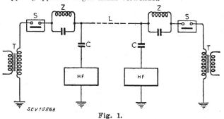
Prinzip des Anschlusses der Trägerwellenapparatur an eine Hochspannugsleitung
