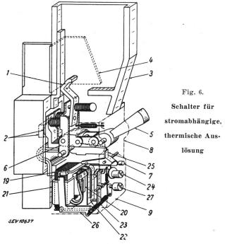
Bei der stromabhängigen, thermischen Auslösung (Fig. 6) befindet sich an Stelle des Zeitmotors ein kleiner Transformator, welcher primärseitig vom Netzstrom durchflossen wird und sekundärseitig
