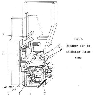
Pos. 1 der Abbrennkontakt, wo der Schaltfunke infolge zweckmässig angebrachter Eigenblasung in das Funkenkamin geschleudert und dort kräftig gekühlt und gelöscht wird. Die Auslösestromstärke kann in den Grenzen 1:2, die Zeitauslösung bei 50 per./s von 0,2 bis 0,4 s und die Schnellauslösung auf den 3- bis 7fachen Nennstrom eingestellt werden.
