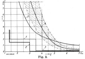
Kennlinien für stromunabhängige Hauptstrom-Auslöser oder -Relais, thermische -Auslöser und Sicherungen
