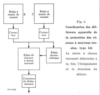
des lignes à haute tension, a été gardé sans modification. Comme on le sait 1), il détermine en même temps l'éloignement et la direction du défaut et ceci d'une façon tout à fait particulière: en cas de défaut sur le tronçon protégé (fig. 4), il fonctionne dans le sens positif, ferme son contact et provoque ainsi le déclenchement du disjoncteur. Si le dé-
