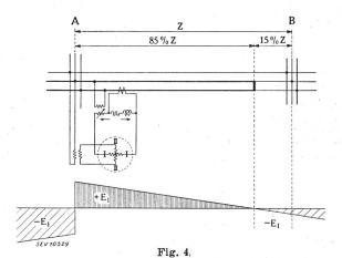
Principe du relais de distance à champ tournant AB Tronçon protégé par le relais en A. Le relais détache, par le seul effet d'une rotation dans un sens ou dans l'autre, le tronçon avarié du reste du réseaux.
