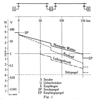
Schematische Darstellung der Ausbreitungsverhältnisse von Hochfrequenzwellen auf Hochspannungsleitungen Bemerkenswert ist der Einfluss von Rauhreif auf die Leitungsdämpfung. Bei Leitungsbruch wird der Empfangspegel dem Störpegel vergleichbar und damit eine Verbindung unter Umständen verunmöglicht.
