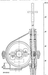
50 cm dieser kleinen Zentrifugen. Aber erst vor wenigen Jahren wurden Spindelmotoren fertig entwickelt. die Ansprüchen für Zentrifugen von 170 mm lichter Weite, 150 mm lichter Höhe und 2,5 kg Fassungsvermögen bezug auf Leistung, Drehzahl bis 10 000/ Unempfindlichmin, keit gegen Unbalancen,
