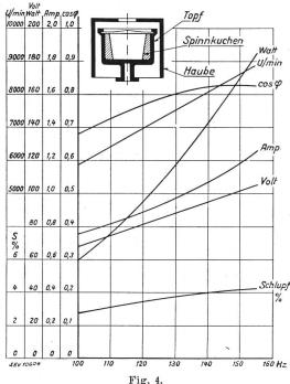
Elektrische Charakteristik des «Oerlikon»-Spindelmotors
