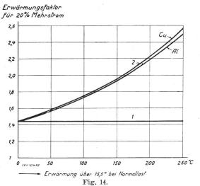
Faktoren für die Mehrerwärmung bei 20 % Mehrstrom ohne (1) und mit (2) Berücksichtigung der Widerstandszunahme.
