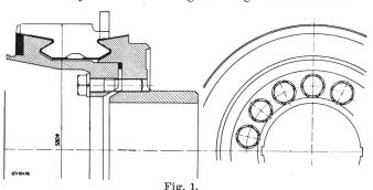
Kollektor eines Gleichstrom-Lokomotivmotors
