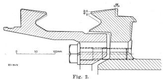
Bleibende Verformung des Kollektors nach Fig. 1, gemessen, Verformung im 10fachen Maßstab.
