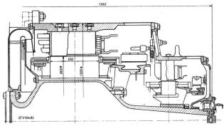
Fig. 5. Gleichstromgenerator für dieselelektrische Lokomotive (Längssehnitt)
