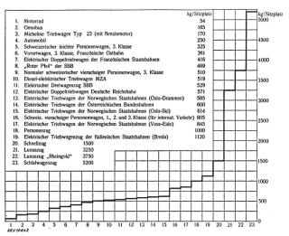
$\begin{aligned} & & \text{Fig. 1.} \\ \textbf{Sitzplatzgewichte für verschiedene Fahrzeugarten} \\ &= \frac{\text{Fahrzeugleergewicht}}{\text{Sitzplatzzahl}} \end{aligned}$
