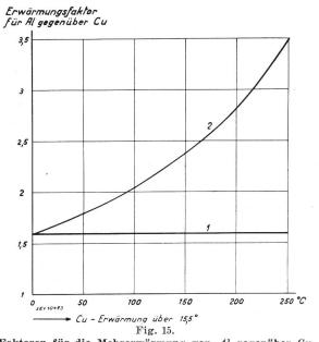
Faktoren für die Mehrerwärmung von Al gegenüber Cu bei gleichem Querschnitt ohne (1) und mit (2) Berücksichtigung der Widerstandszunahme.
