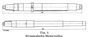
Drehmoment und Zahndruck der unteren Welle 1,5fach gegenüber der oberen Welle.
