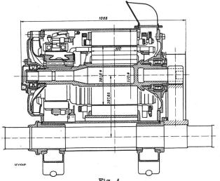
Fig. 4. Einphasen-Bahnmotor mit Zapfenkolben (Längsschnitt)
