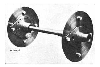
Fig. 2. Kardanwelle zum Brown-Boveri-Scheibenantrieb
