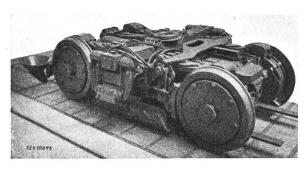
Fig. 4. Simplex-Drehgestell, Bauart Zürich
