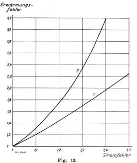
Faktoren für die Erwärmung bei Mehrstrom ohne (1) und mit (2) Berücksichtigung der Widerstandszunahme. Ausgangspunkt:  $\Delta\vartheta=100^\circ$  über 15,5° bei Strom 1.
