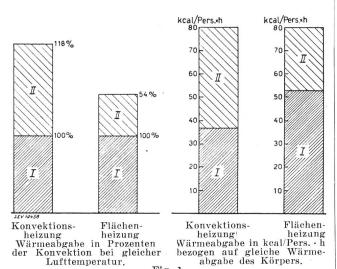
Fig. 1. Wärmeabgabe eines normal bekleideten Menschen unterteilt in Konvektion (Abströmung) (I) und Abstrahlung (II) bei Konvektions- und Flächenheizung.
