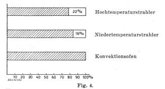
Vergleich der Dauerleistung verschiedener elektrischer Oefen Schraffiert: Der optimalen Behaglichkeit 1,5 m vom Ofen entsprechende Dauerleistung.
