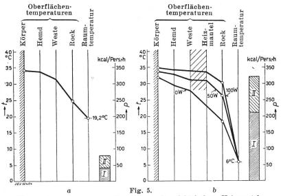
Temperaturmessungen zur Beurteilung des elektrischen Heizmantels.
