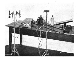
Fig. 2. Elektrische Messausrüstung. Links der sog. «künstliche Mensch», d. h. Katathermometer, für eine Oberflächenmesstemperatur von 24,5°C mit automatischer elektrischer Uebertragung der Abkühlungszeiten auf Stoppuhren. Rechts Ausrüstung zur Feststellung von Luftund Oberflächentemperaturen mit Thermoelementen.
