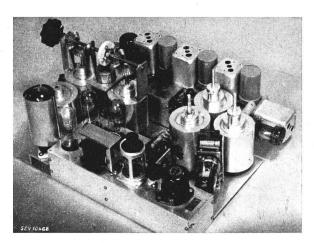
Fig. 1. Sender und Empfänger für eine Wellenlänge zwischen 50 und 100 cm
