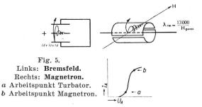
Amplitude an das Wechselfeld abgeben, bis sie schliesslich vom Gitter aufgefangen werden (Fig. 5). Die Leistung dieses Generators ist begrenzt durch die thermische Belastbarkeit des Gitters.
