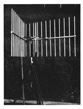
Fig. 2. Richtantenne für Sender und Empfänger nach Fig. 1
