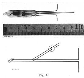
Empfänger Oben: Empfangsmagnetron. Unten: Schaltung.
