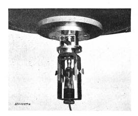
Fig. 9. Turbator an Richtspiegel befestigt.
