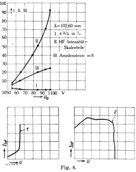
Vergleich der Steuerkurven von Turbator (oben) und Magnetron (unten)
