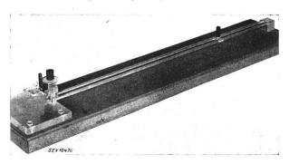
Fig. 3. Lechersystem mit einstellbarer Kapazität am einen Ende (Q-Meter für dm-Wellen.)
