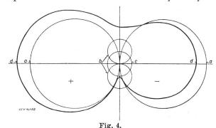
Verzerrung der Rahmencharakteristik durch Dielektrischenund Antennen-Effekt
