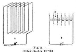
a Rahmenantenne. b Fiktive Schlaufe, gebildet über die Windungskapazitäten. c Windungskapazitäten.
