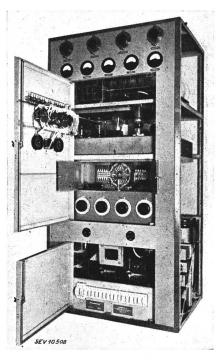
Fig. 10. Nahzonen-Sender für den Flugsicherungsdienst
