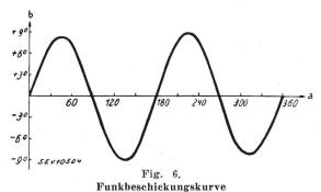
a Achse: rohes Funkazimut. b Achse: Beschickungswert.
