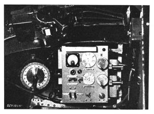
Fig. 12. Kommandogerät zu Flugzeugsender
