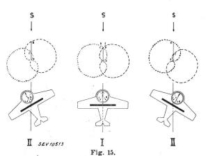
Schematische Darstellung der Kardioïdentastung beim Zielfluggerät
