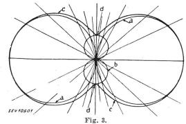
Verzerrung der Rahmencharakteristik durch den dielektrischen Effekt
