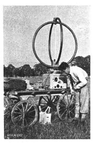
Fig. 14. Grossbereich-Peilempfänger mit Kreuzdrehrahmen
