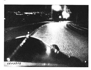
Fig. 4. Forchstrasse ob Rehalp bei Regen. Fahrbahn Kleinpflästerung, Trottoir geteert. Gute Beleuchtung.
