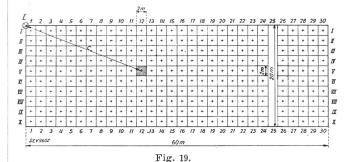
Flächeneinteilung für die Berechnung des Boden-Beleuchtungs-Wirkungsgrades.
