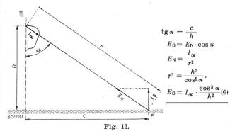
Berechnung der Bodenbeleuchtungsstärke  $E_{\rm B}$  nach der Punkt-Methode.
