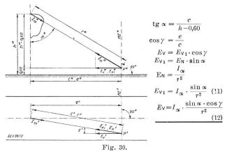
Berechnung der Vertikalbeleuchtungsstärke  $E_V$  nach der Punkt-Methode.
