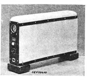
Beschreibung: Elektrischer Heizofen (Halbspeicherofen) gemäss Abbildung. Heizwiderstand in einen mit Rippen versehenen und mit Drahtgeflecht umgebenen Betonkörper eingebaut. Füsse mit Rollen versehen. Apparatestecker, zweipoliger Schalter, Signallampe und Schaltuhr eingebaut.
