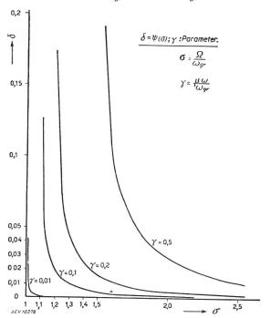
sich  $\delta$  als Funktion von  $\sigma$  mit  $\gamma$  als Parameter berechnen (vgl. Fig. 1).
