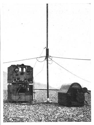
Fig. 3. Militärfunkgerät in Panzerholzgehäuse
