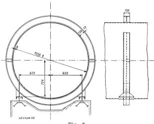
Fig. 2. Vue d'un appui annulaire.
