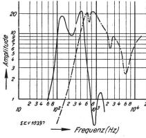
Fig. 17. Filterkurven für die Erzeugung einer Klangfarbe mit Formanten und einer andern mit stark ausge-prägten hohen Teiltönen
