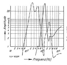
Fig. 16. Filterkurven für Filterkurven für die Erzeugung zweier Klangfar-ben mit Forman-ten, die, auf ver-schiedene Stim-men verteilt, sich gut im mehrstim-migen Satz er-einzen gänzen
