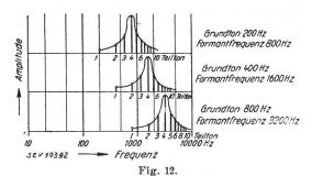
Bild eines «wandernden Formanten», erzeugt im stufenweise abstimmbaren Filter des «Melodiums»
