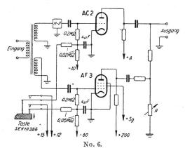
Schaltung und mechanische Auslösevorrichtung für künstliche Darstellung von Anklingvorgängen mit ungleichem Kurven-verlauf verschiedener Frequenzbereiche
