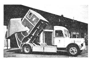
Fig. 3. Elektrofahrzeug für die Kehrichtabfuhr mit gekipptem Kehrichtbehälter
