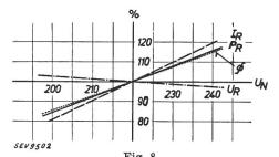
Abhängigkeit der Leistung (P) und des Lichtstromes  $(\Phi)$  von der Netzspannung  $(U_N)$ .
