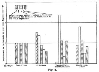
Die Farbanteile des Lichtes der Glühlampe, der Quecksilberhochdrucklampe und der Quecksilbermischlichtlampe im Verhältnis zu den entsprechenden Farbanteilen beim Tageslicht.
