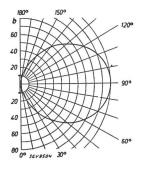
Fig. 10. Lichtverteilungskurve der Leuchtstofflampe
