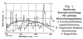
Hg-Strahlung die Lücken mit Leuchtstoffstrahlung so auszufüllen, dass das Spektrum überall von Blau bis Rot die nötige Energiestrahlung hatte. Die drei Leuchtstoffe, Blau, Grüngelb und Rot, konnten den gestellten Anforderungen gerecht werden. Fig. 7 zeigt einen Vergleich der spektralen Energiever-
