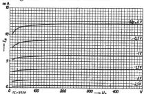
Anodenstrom  $I_a$  als Funktion der Anodenspannung  $U_a$  mit der Gitterspannung  $U_{0\,1}$  als Parameter.  $U_{0\,2}=100~\rm{V}.$
