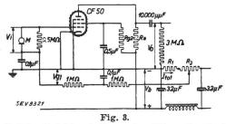
Grundsätzliche Betriebsschaltung der Röhre CF 50 als erste Röhre eines Mikrophonverstärkers mit veränderlicher Steilheit.
