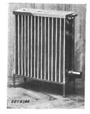
Description: Radiateur électrique selon figure. Le corps de chauffe est monté dans le réservoir d'eau, en tôle de cuivre. Ailettes en tôle d'aluminium pour augmenter la surface de chauffe. Une fiche d'appareil sert au raccordement du cordon d'alimentation.
