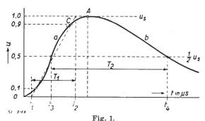
Grandeurs caractéristiques de la tension de choc. T<sub>1</sub> Durée du front. T<sub>2</sub> Durée de mi-amplitude. u<sub>1</sub> Valeur de crête.
