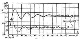
Fig. 6. Widerstand in Abhängigkeit vom Abstand (ebener Reflektor)  $l=25~{\rm cm}(\gamma/2).$
