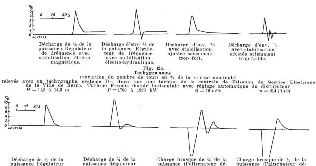
Décharge de ½ de la puissance. Régulateur de la fréquence avec stabilisation électromagnétique. Décharge de ¾ de la puissance. Régulateur de la fréquence avec stabilisation électrohydraulique. Charge brusque de ¼ de la puissance (l'alternateur débite sur une résistance liquide), avec stabilisation électro-hydraulique.
