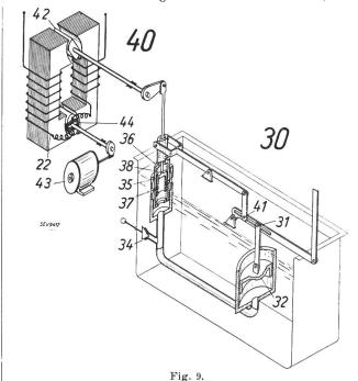
Stabilisateur électro-hydraulique avec mécanisme pour changer l'ajustage du nombre de tours et du statisme.
