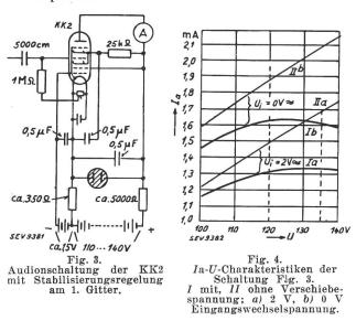
Bis jetzt war von Anodengleichrichtung und Verstärkung die Rede. Bei Gittergleichrichtung (Audionschaltung) sollte die Vorspannung möglichst Null sein: Wenn auch die Regelspannung sehr klein werden kann, so ist es doch zur bessern Gleichrichtung zweckmässiger, hierfür Röhren mit 2 negativen Gittern zu verwenden. An einem findet die Gleichrichtung statt (günstigste Vorspannung an einem Potentiometer quer zur Heizbatterie abgreifbar) und am andern die Regelung.
