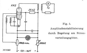
lang zwar, wie die Kurven in Fig. 6 zeigen, die Amplitude der Schwingungen zu stabilisieren, aber die Frequenzkonstanz wurde nicht merklich erhöht.
