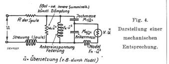
wo z. B. für die Masse des Ankers eine Kapazität eingesetzt wird. Ein solches Beispiel zeigt Fig. 4 (Pic-Up). Beizufügen wäre, dass man bei solchen Schaltungen, sog. mechanischer Entsprechung, immer darauf achten muss, dass die Kondensatoren
