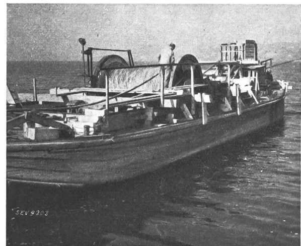
Fig. 6. Aufwickeln des Kabels auf dem Schiff.
