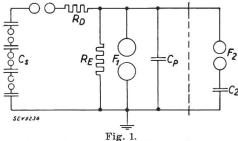
Schema einer normalen Stossprüfanlage.
