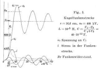
Die Spannung an  $C_2$  erreicht nach  $11 \cdot 10^{-8}$  s den Scheitelwert von 455 kV. Sie ist also höher als die ursprüngliche Stoßspannung (400 kV). Die *mittlere Steilheit* beträgt 8200 kV/ $\mu$ s.
