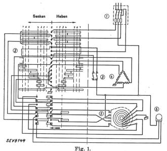
Schema zum Kontroller für Zweistufenmotor.
