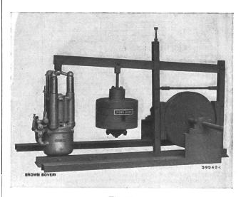
Fig. 7. Vérin électro-hydraulique servant au déblocage d'un frein.
