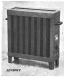
Description: Radiateur électrique selon figure. Le fil résistant, enroulé en boudin, est fixé sur les deux faces de deux plaques en éternite superposées; celles-ci sont montées dans un cadre en tôle de fer. Les plaques d'éternite sont isolées des pièces métalliques accessibles. Les parois latérales munies d'ailettes, sont en tôle d'aluminium. Un interrupteur encastré permet de régler la puissance de chauffe. Une
