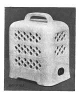
Description: Radiateur électrique en faïence, selon figure. Le fil résistant enroulé en boudin est fixé sur une pièce cylindrique en matière céramique, disposée horizontalement dans un bâti en faïence. Des plaques en éternite et en amiante empêchent le rayonnement de la chaleur vers la base du radiateur. Une fiche d'appareil encastrée sert au raccordement du cordon d'alimentation.
