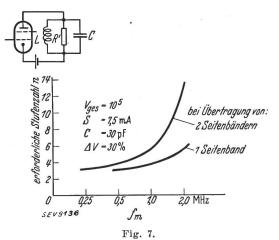
Zahl der Verstärkerröhren bei wachsender Breite des Frequenzbandes.
