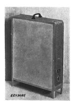
Description: Radiateur électrique selon figure. La résistance de chauffe est constituée par du fil de cuivre émaillé, enroulé sur des tubes en aluminium, isolés au moyen de papier bakélisé. Ces tubes, au nombre de vingt, sont disposés verticalement en deux rangées et montés dans un bâti métallique dont ils sont isolés. Une fiche d'appareil sert au raccordement du cordon d'alimentation.
