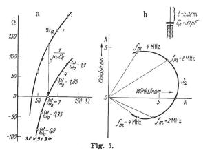
Fusspunkts-Widerstand und -Strom der 1/4-Wellenlängen-Antenne mit Verkürzungskondensator.
