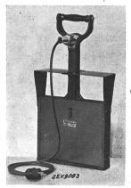
Descriptions: Plongeur selon figure, servant à chauffer l'huile traitée dans les installations de régénération. Corps de chauffe de forme plate monté dans un bâti en fonte muni d'ailettes. Le bâti est recouvert de parois en tôle. Raccordement au réseau au moyen d'un cordon à gaine de caoutchouc à 3 conducteurs, muni d'une fiche 2 P + T.
