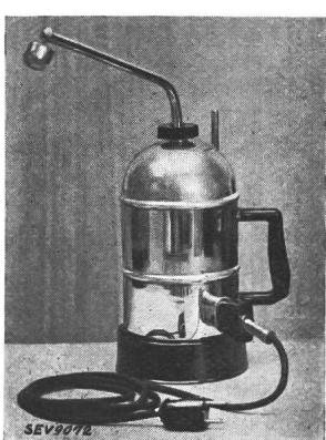
Description: Inhalateur avec chauffage latéral, selon figure. Capacité jusqu'au rebord: 2,3 litres. Raccord fileté pour la fixation du tuyau d'évaporation. Le pied et la poignée sont en matière isolante moulée. Hauteur du pied: 45 mm. Fiche d'appareil pour le raccordement du cordon d'alimentation. Raccordement au réseau au moyen d'un cordon rond à 3 conducteurs muni d'une fiche 2 P + T et d'une prise d'appareil.
