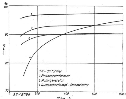
Gesamtwirkungsgrad einer Kontaktumformeranlage im Vergleich mit Maschinenumformern und Quecksilberdampfmutatoren bei 5000 A in Abhängigkeit von der Nennspannung. Rund  $\frac{1}{3}$  der Verluste der Kontaktumformeranlage liegen im Transformator.
