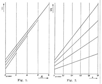
(Fig. 1). Diese Geraden entsprechen gleichartigen Kraftwerken gleicher technischer Entwicklungsstufe. Dargestellt sind die Kostengeraden für vier Kraftwerke mit relativen Leistungswerten 1, 2, 3 und 4. Wenn man auf diesen Kostengeraden Punkte desselben Ausnützungsfaktors verbindet, so erhalten wir Kostenkurven der konformen Belastungen. Sie wären Geraden, wenn die spezifischen Anlagekosten und die spezifischen Arbeitskosten verschieden grosser Werke gleich wären.
