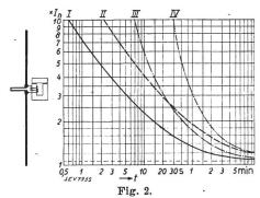
Auslösekurven von normalen Bimetallen und Bimetallen mit induktivem Nebenschluss,
