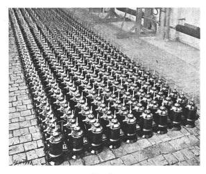
Fig. 6. Spinnzentrifugen-Motoren.
