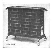
Description: Radiateur électrique à accumulation selon figure, constitué par des briques rouges maçonnées. Le fil résistant enroulé en boudin, est disposé dans 12 trous verticaux traversant le radiateur. Un interrupteur de réglage permet de faire fonctionner le radiateur à pleine ou demi charge. Une fiche d'appareil sert au raccordement du cordon d'alimentation.
