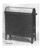
Description: Radiateur électrique selon figure. Le fil résistant est enroulé sur huit cadres métalliques superposés et isolés du bâti en aluminium. Les parties supérieure et inférieure du bâti sont constituées par de la tôle ajourée et du treillis, de manière à assurer une bonne ventilation. Les poignées sont en matière isolante. Une fiche d'appareil sert au raccordement du cordon d'alimentation.
