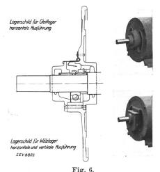
Wälzlager und Ringschmierlager mit der gleichen Welle.
