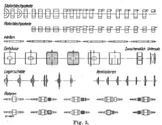
Der Baukasten für elektrische Maschinen.
