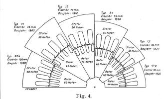
Die Entwicklung des magnetischen Kreises seit 1900. Entwicklung der Blechschnitte des Drehstromkäfiganker-Motors 2,2 kW, 4polig, 50 Hz. Baujahr 1900—1935.
