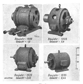
Fig. 2. Die äussere Form des Drehstrommotors im Wandel der Zeit.
