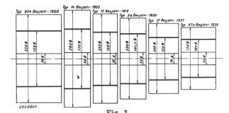
Der Materialaufwand 1900—1935. Entwicklung der Blechpaketabmessungen des Drehstromkäfiganker-Motors 2,2 kW, 4polig, 50 Hz.
