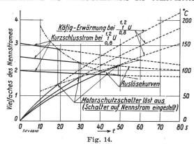
Erwärmungskurven der Käfigwicklung bei Drehstromspeisung des Stators und festgebremstem Rotor. Drehstrom Combi-Motor Typ 51c, 4polig, 5,5 kW, 380 V, 11,7 A, 50 Hz, 1420 U/min.
