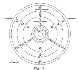
Schaltschema des Rotorstromkreises des Combi-Motors.
