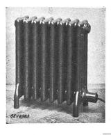
Description: Radiateur électrique selon figure, composé de 8 éléments remplis d'huile. Le corps de chauffe est monté dans la partie inférieure de l'appareil. Raccordement au réseau au moyen d'un cordon à gaine de caoutchouc à 3 conducteurs, muni d'une fiche et fixé à demeure.
