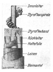
Fig. 1. Koaxiales Breitbandkabel.
