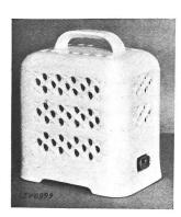
Description: Radiateur électrique en faïence, selon figure. Le fil résistant enroulé en boudin est fixé sur deux pièces cylindriques en matière céramique, disposées verticalement, l'une à côté de l'autre, dans un bâti en faïence. Des plaques en éternite et en amiante empêchent le rayonnement de la chaleur vers la base du radiateur. Une fiche d'appareil encastée, avec collet métallique, sert au raccordement du cordon d'alimentation.
