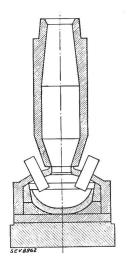
steht aus diesem Prozess Roheisen, welches dann im Stahlofen durch Entfernung des Kohlenüberschusses und anderer Begleitelemente in Stahl verwandelt wird. Die Zugabe von Kohle ist ferner zur Auflockerung der Beschickung nötig, um diese luftdurchlässig zu machen.
