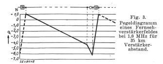
Die Abhängigkeit der Dämpfung eines solchen Leiterabschnitts (Verstärkerfeld) von der Frequenz ist in Fig. 2 dargestellt. Fig. 3 zeigt ein Pegeldiagramm. Da die elektrische Länge der einzelnen Leiterabschnitte von vorneherein nicht
