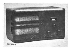
Description: Appareil de télédiffusion selon figure, sans transformateur de réseau, pour service sous courant continu ou alternatif. Haut-parleur électrodynamique.
