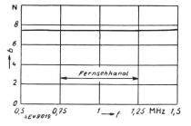
Fig. 6. Verstärkungsziffer des Fernsehverstärkers.
