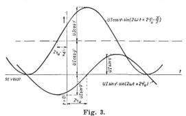
eine schwingt mit dem Scheitelwert  $UI\cos\varphi$  um den Mittelwert  $UI\cos\varphi$ ; ihr Nullphasenwinkel ist  $\left(2\,\varphi_u-\frac{\pi}{2}\right)$ . Die zweite Schwingung eilt der ersten wegen ihres Nullphasenwinkels  $2\,\varphi_u$  um 90 ° nach und hat den Scheitelwert  $UI\sin\varphi$ ; ihr zeitlicher Mittelwert ist Null. Der zeitliche Mittelwert beider Schwingungen, also der gesamten Leistung, ist daher  $UI\cos\varphi$ .  $P=UI\cos\varphi$
