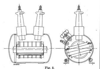
Einphasendruckgasspannungswandler für Nennspannung 11 kV im Längs- und Querschnitt.
