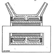
Fig. 2. Vollständig trocken-isolierter Spannungs-wandler für Nennspan-nung 10 kV in kerami-schem Gehäuse.
