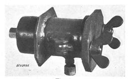
Fig. 5. Betriebsluftentfeuchter für Druckgaswandler.
