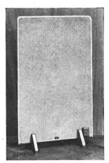
Description: Radiateur électrique selon figure. La résistance de chauffe est composée d'une feuille d'aluminium placée entre deux plaques d'éternite. Une couche de laine de verre diminue le rayonnement de la chaleur vers la face arrière du radiateur. Raccordement au réseau au moyen d'un cordon rond à 3 conducteurs, muni d'une fiche.
