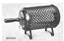
Description: Radiateur électrique selon figure. La résistance de chauffe, sous forme de boudin, est enroulée sur deux plaques d'éternite et fixée dans un bâti en tôle ajourée. Un écran en tôle est placé au-dessus du corps de chauffe. Les
