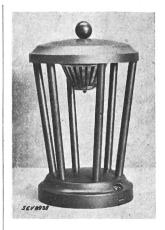
Description: Radiateur électrique (à rayonnement dirigé vers le bas) selon figure. Le corps de chauffe, constitué par du fil résistant enroulé en boudin et fixé sur un support en matière céramique, est monté sous un réflecteur plan, en tôle chromée. La base, la partie supérieure et les barreaux reliant ces deux pièces sont en tôle; la poignée est en matière isolante. Une fiche d'appareil sert au raccordement du cordon d'alimentation.
