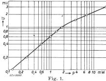
Gleichstromeichung des Vakuum-Thermokreuzes Typ R-446-4. Voltmeterwiderstand 10 Q. Heizdrahtleistung (P) in Milliwat in Funktion der Spannung (U) des Thermoelements in Millivolt.
