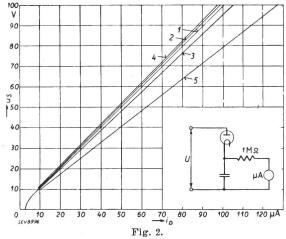
Eichung des Diodentyps R-353 als Scheitelspannungsmesser. Diodenstrom (i) in  $\mu$ A in Funktion der Scheitelspannung ( $\mu$ s) in Volt. 1 60 Per./s. 2  $\lambda=100$  cm, mit Laufzeitkorrektur. 3  $\lambda=100$  cm, mit Laufzeit- und Resonanzkorrektur. 4  $\lambda=50$  cm, mit Laufzeitkorrektur. 5  $\lambda=50$  cm, mit Laufzeit- und Resonanzkorrektur.
